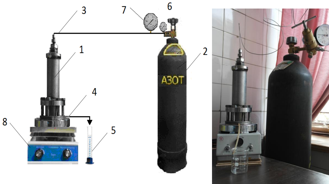
Рис 2.4. Схема та загальний вигляд експериментальної баромембранної установки фронтального фільтрування: 1 – баромембранна комірка; 2 – балон зі стислим азотом; 3 – газопідвідна трубка; 4 – вихід пермеату; 5 – збірник пермеату; 6 – редуктор; 7 – манометр; 8 – магнітна мішалка
