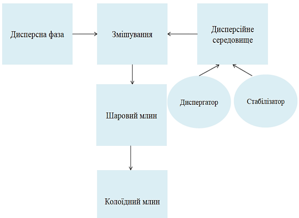
Рис. 3.13 Технологічна схема приготування висококонцентрованої суспензії на основі вугілля і рідких органічних речовин
