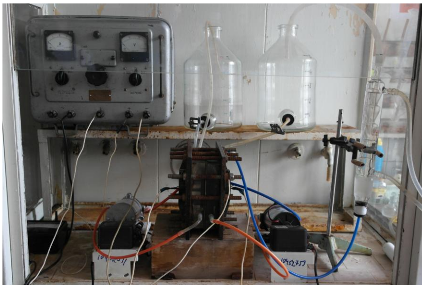
Рисунок 2.11 – Общий вид экспериментального электродиализного концентратора-разделителя
