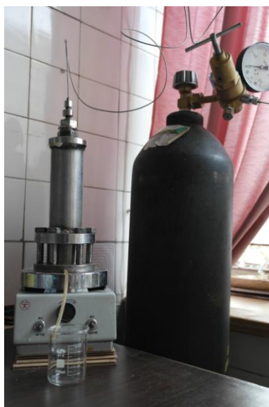
Рисунок 2.5 – Общий вид экспериментальной обратноосмотической установки непроточного типа
