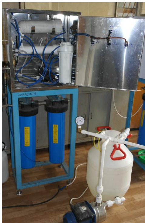
Рисунок 2.9 – Общий вид промышленной обратноосмотической установки рулонного типа с рециркуляцией производительностью до 40 \text{ дм}^3/\text{ч}
