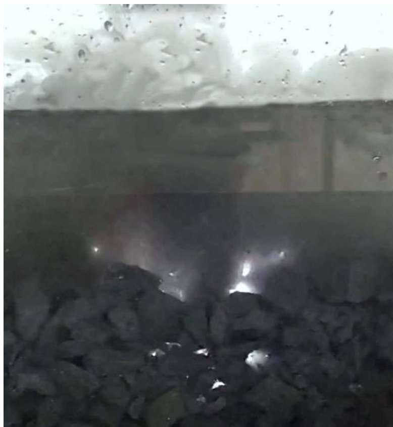
Рисунок 26 – Утворення плазми в завантаженні каскадного реактора.
