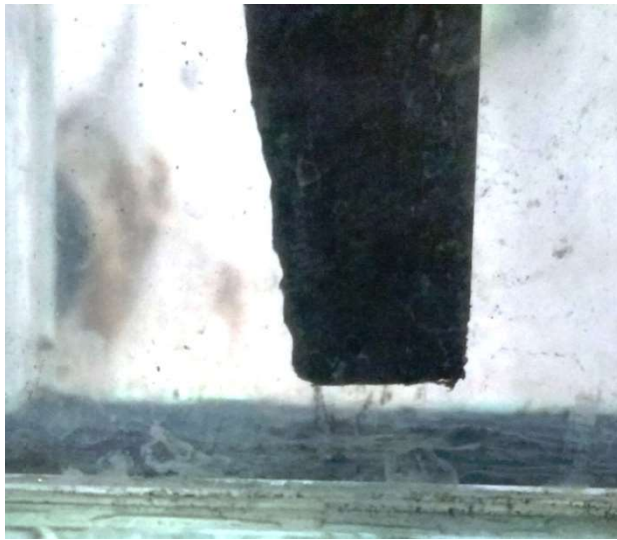
Рисунок 22 – Характерний клиноподібний знос контактних поверхонь електрода.
