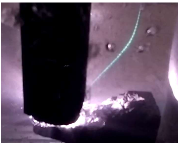
Рисунок 23 – Типовий вид плазмового факел у водному середовищі між електродами.
