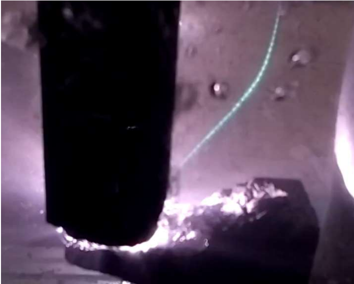
Рисунок 1 – Типовий вид плазмового факел у водному середовищі між електродами.
